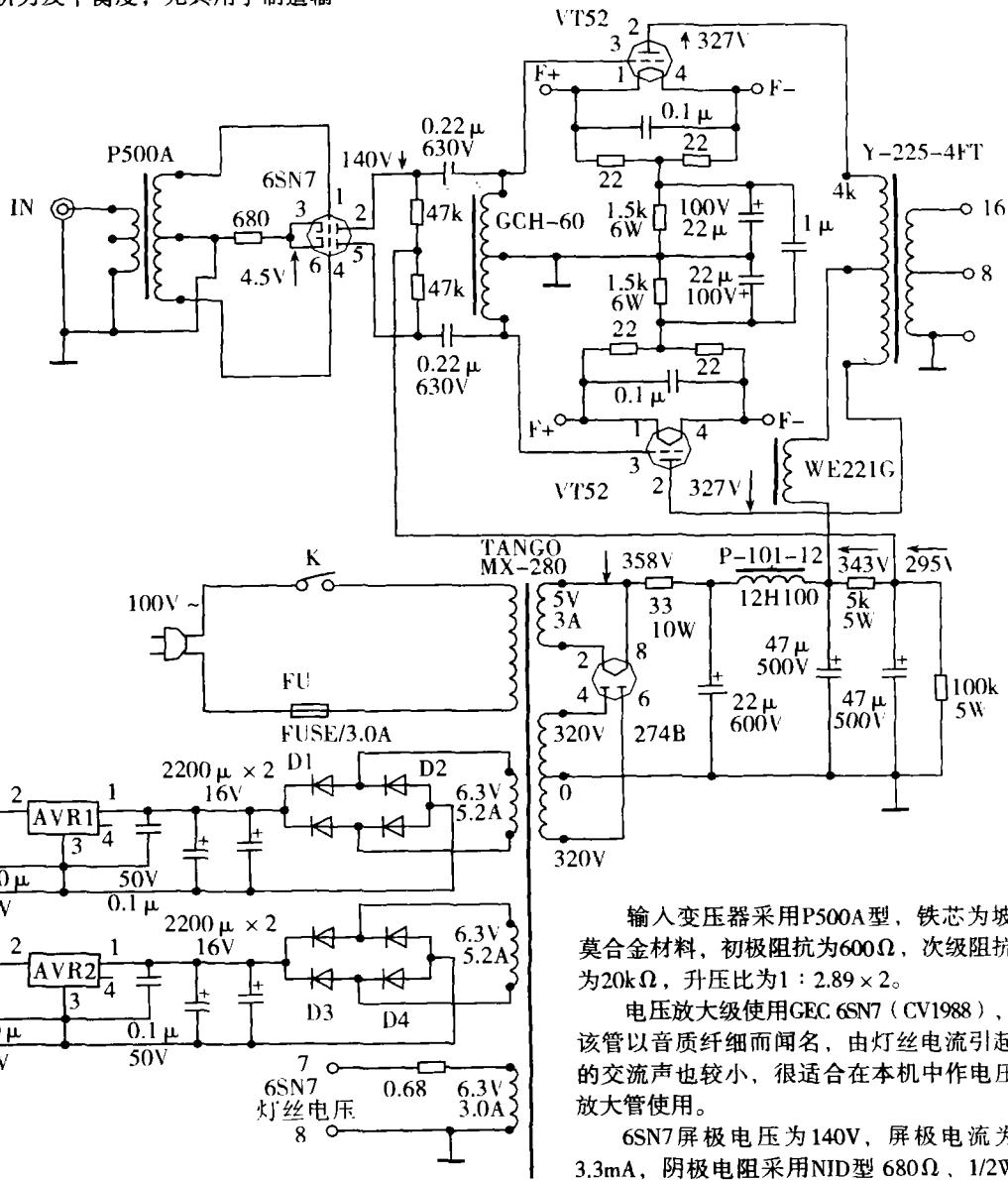
输入变压器采用P500A型，铁芯为坡莫合金材料，初极阻抗为 $600\Omega$ ，次级阻抗为 $20k\Omega$ ，升压比为 $1:2.89 \times 2$ 。
