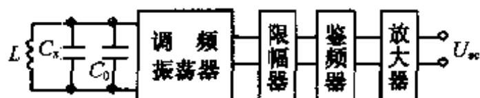
图 6-17 调频—鉴频电路框图
